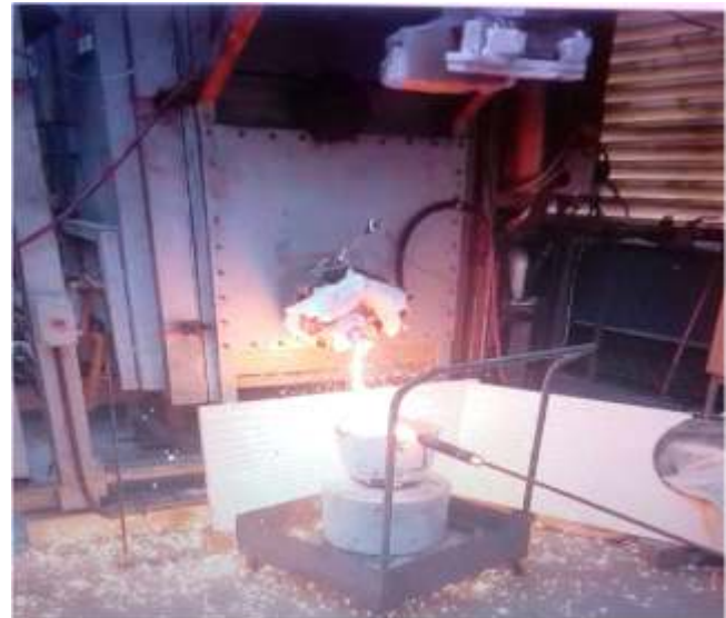
Figure5: Tapping of hot molten material (metal + slag)
